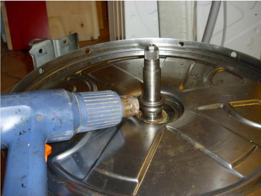
Lagerwechsel Waschmaschine mittels Hitze
