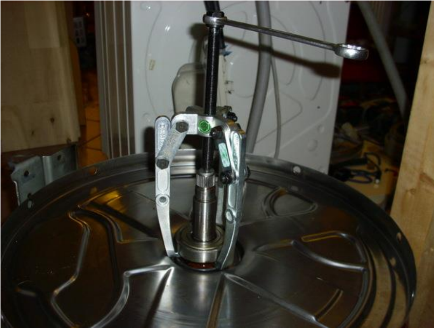
Lagerwechsel Waschmaschine mittels Abzieher
